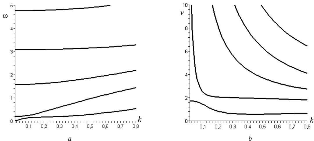
Рис. 4. Зависимость частоты (а) и фазовой скорости (b) для изотропного цилиндра
