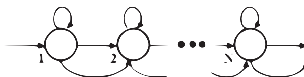
Рис. 1. Структура лево-правой СММ Fig. 1. The structure of the left-right hidden Markov models (HMM)
